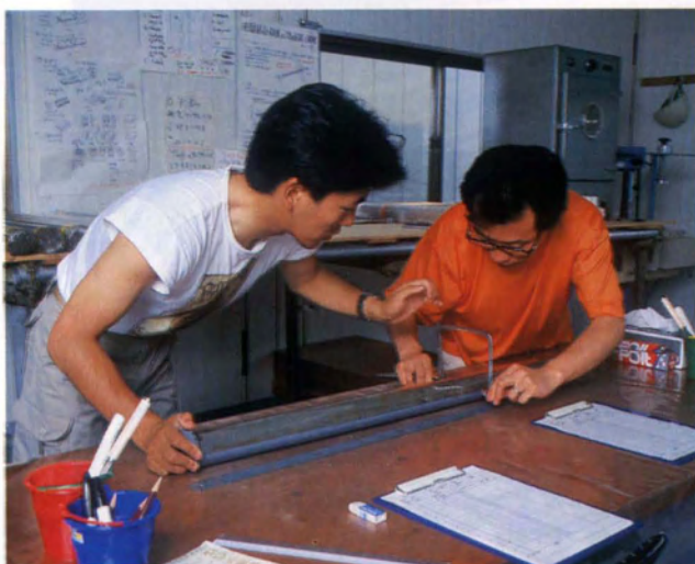
②ワイヤーソーにより、コアを半分に割る切断作業
