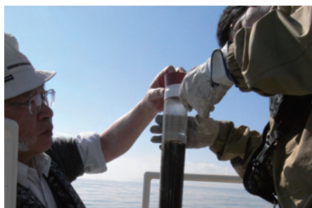
【写真2】琵琶湖の底の泥を 採取している様子
