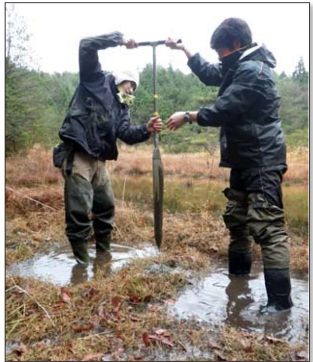
写真：油日湿原でのボーリング調査の様子
