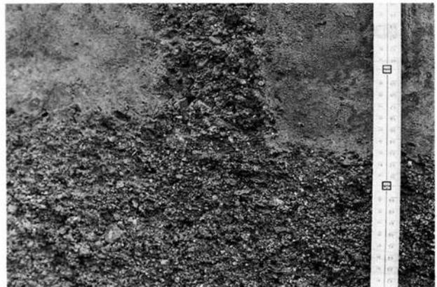
写真5 写真4の近景（粗い粒子が液状化している）
