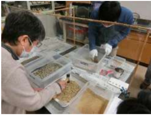
〔固まっている土をハンマーで細かく砕く作業中〕
