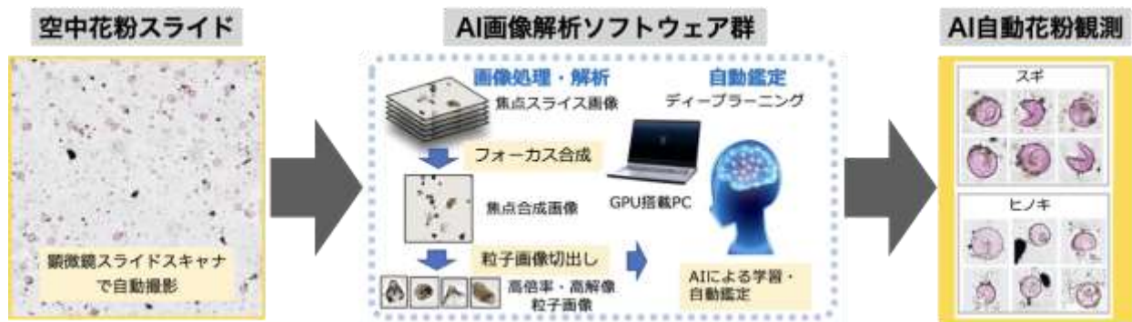
図1 「AI 自動花粉同定システム」の概要
