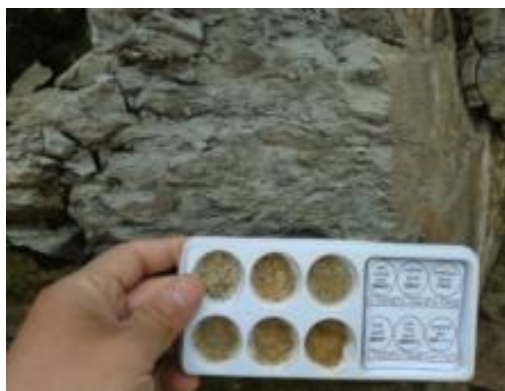
粒度表で地層の粒度を確認しながらスケッチ
