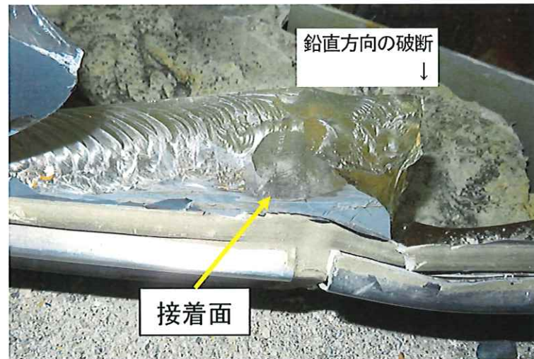
図4 アクリル水槽本体側破断面 (B) のアクリル板接着の痕跡
