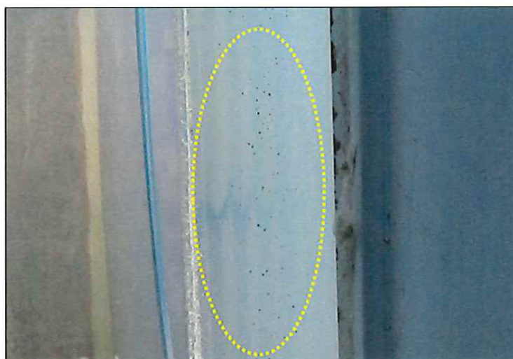
図 20 アクリル樹脂内部のボイドもしくは異物の様子
