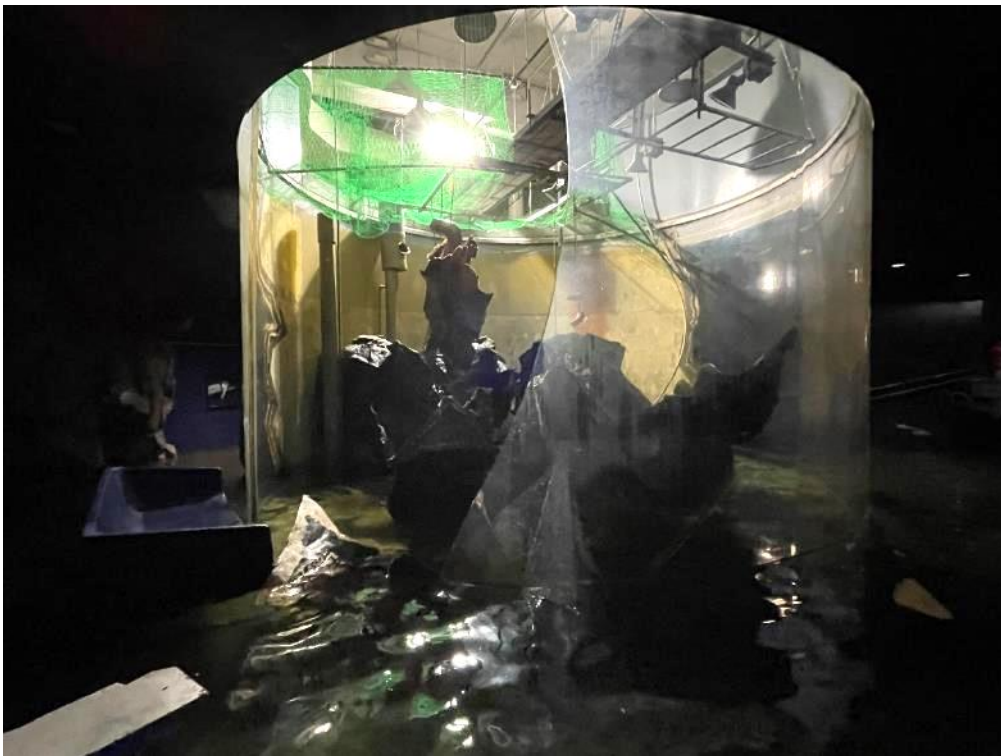
破損したビワコオオナマズ水槽
