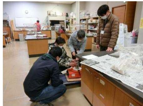
【篩を重ね、機械に固定して振動をかけます】
